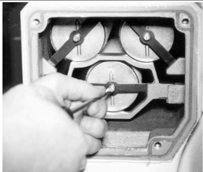
Fig. 4 - Scoaterea clemei cu arc a filtrului
